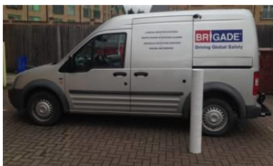
1m lange paal onder een camera gemonteerd op 1,8m
